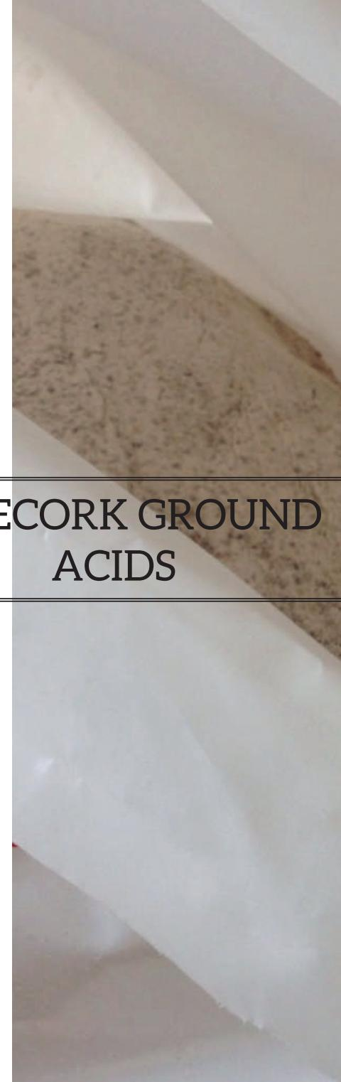
Per i cilindretti si utilizza ECORK GROUND come materiale di riempimento e, come rivestimento, un Tessuto Non Tessuto ad alta resistenza al punzonamento ed alla lacerazione, realizzato per oltre il 70% in peso con PET di recupero dalla raccolta differenziata.
